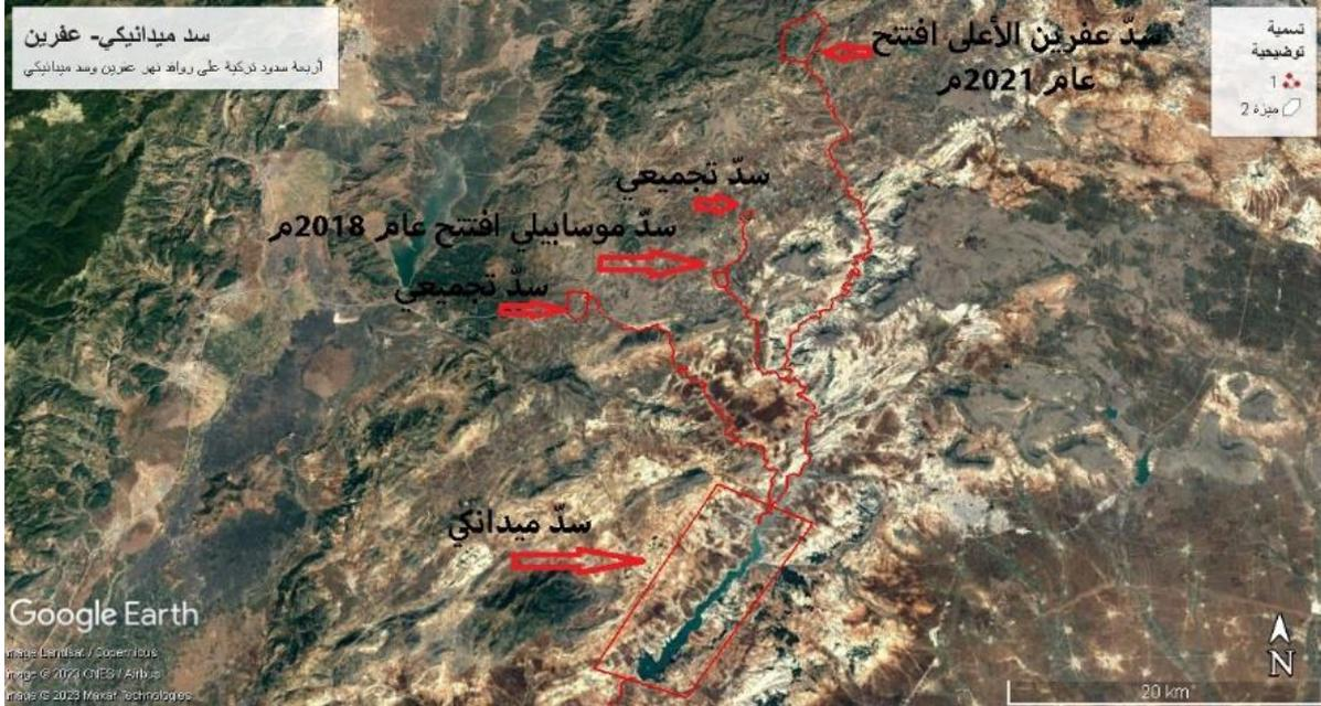
Selon une source privée, le volume de stockage régulier du barrage de Maydanki (190 millions de mètres cubes) est à un niveau de 335 mètres, et le volume de stockage minimum est au niveau de 298 mètres, alors que le niveau actuel est de 322 mètres et le niveau minimum pour que le barrage fonctionne est de 320 mètres ou (12,5 millions mètres cubes).
